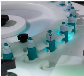
Transporte mediante rueda dentada para un control de botellas positivo durante el marcado.
